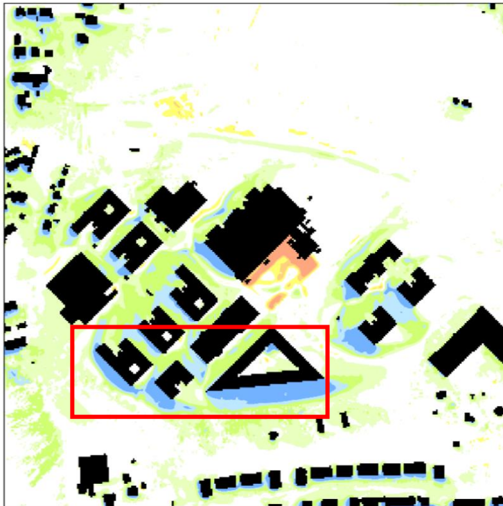
Abbildung 9: Quartier STEP: PET tagsüber. Differenz zwischen Fassadenbegrünung (Planfall) und aktuellem Zustand (Status quo).
