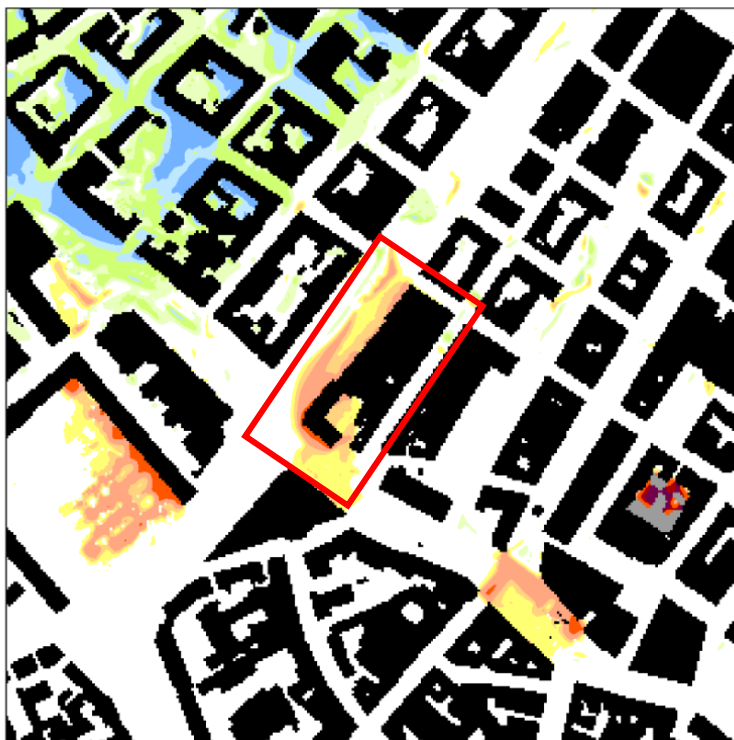
Abbildung 10: Quartier Calwer Passage: PET tagsüber. Differenz zwischen Entfernung von Begrünung (Planfall) und aktuellem Zustand (Status quo).
