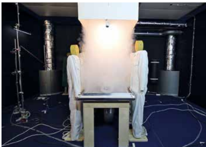
Abbildung 8: Lufteinbringung über das Zuluftfeld
