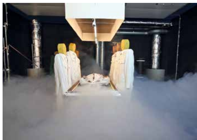
Abbildung 9: Lufteinbringung über Schichtluftdurchlässe
