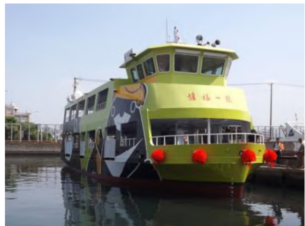
Abbildung 98 Vollelektrische Fähre: Qi-Fu No.1 Bildquelle: Baumüller 2022
