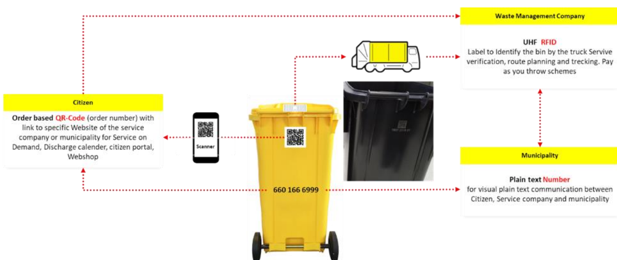
Abbildung 92: Beispiel eines digitalisierten Abfallsammelsystems Quelle: Goduni International GmbH und SSI Fritz Schäfer GmbH
