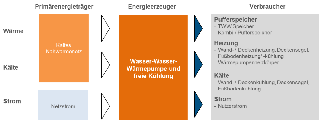
Abbildung 52: Energie-Effizienzkonzept 5 kaltes Nahwärmenetz (zentral) (siz energieplus)
