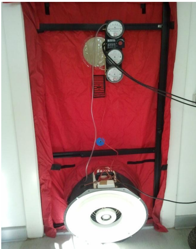
Abbildung 3: Blower-Door-Test, Quelle: energydesign braunschweig GmbH
