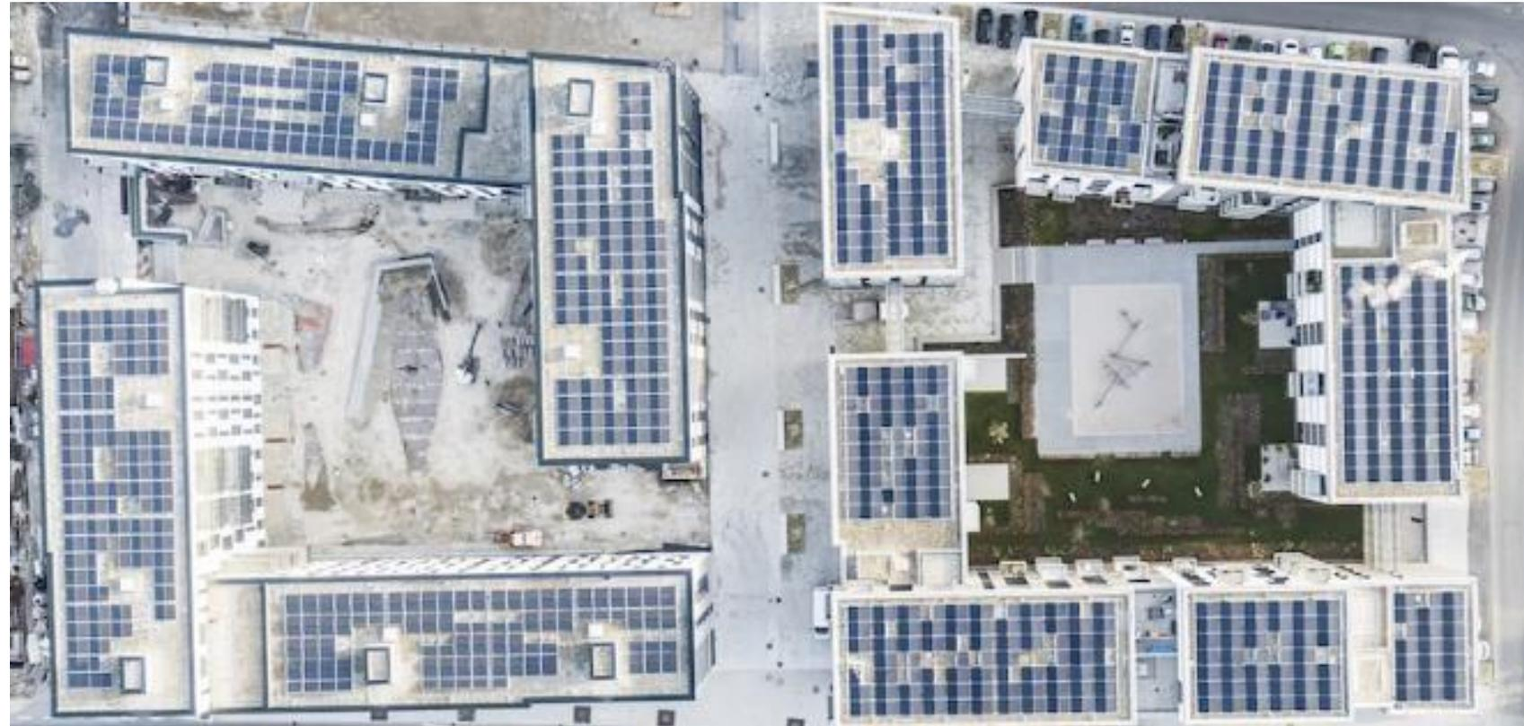
Erneuerbare Stromproduktion - installierte PV: 1.440 kW<sub>p</sub>
