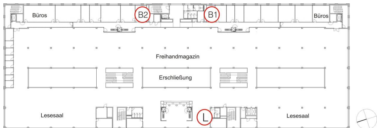
Abbildung 101: Grundriss 3.Obergeschoss mit eingezeichneten Räumen für Messung thermischer Komfort [Quelle: Architekturbüro Walter A. Noebel, Berlin]
