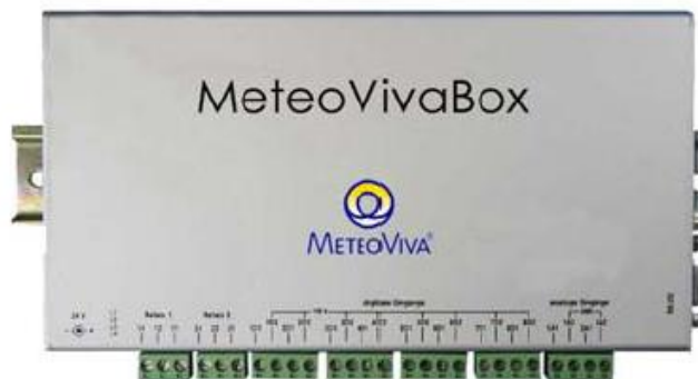
Abbildung 7: MeteoVivaBox dient vor Ort der Übertragung von Mess- und Steuerdaten [8]
