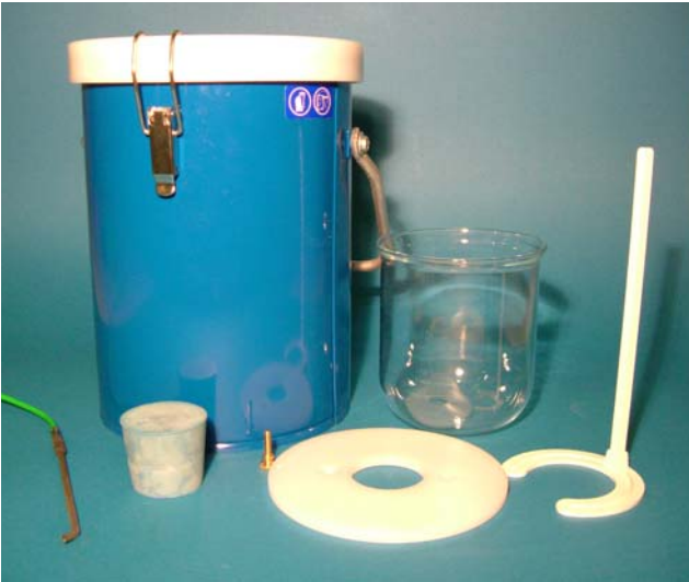
Abbildung 6: Versuchsstand zur Ermittlung der Wärmekapazität
