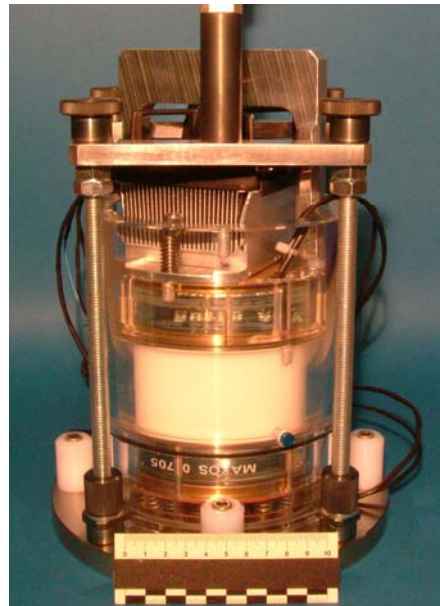
Abbildung 1: Apparatur zur Bestimmung der Wärmeleitfähigkeit von Bodenproben mit einem max. Durchmesser von 10 cm
