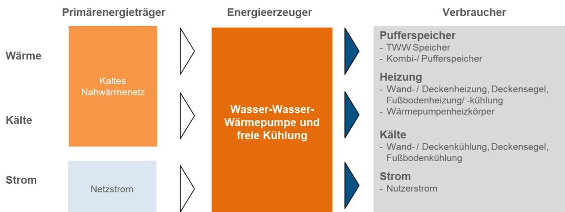
Abbildung 52: Energie-Effizienzkonzept 5 kaltes Nahwärmenetz (zentral) (siz energieplus)
