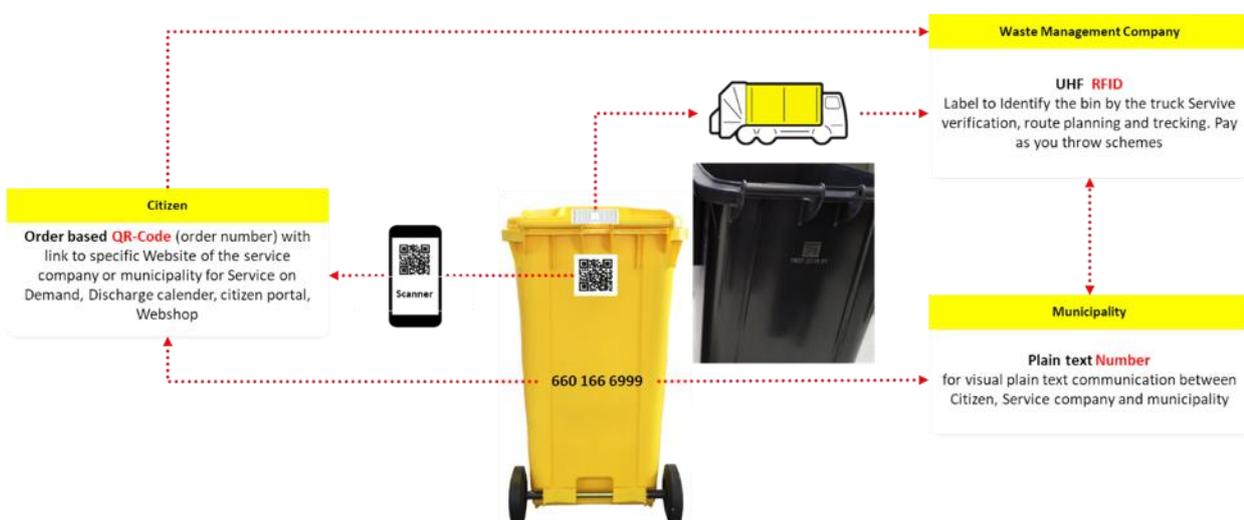
Abbildung 92: Beispiel eines digitalisierten Abfallsammelsystems
