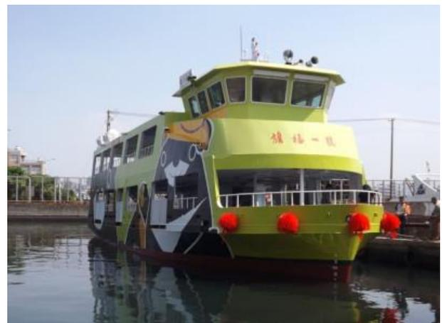
Abbildung 98 Vollelektrische Fähre: Qi-Fu No.1
