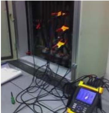
Abbildung 27 Beispiel für den Aufbau des Messgeräts an einem Schaltschrank
