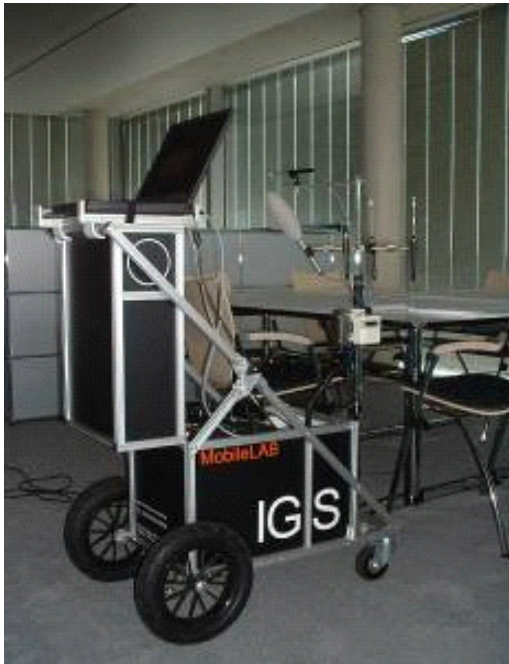
Abbildung 30 Messtechnikaufbau des MobileLAB
