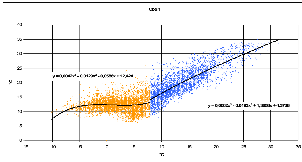
Abbildung 109 Approximierung der gemessenen Abhängigkeit der Atriumtemperatur von der Außentemperatur, oberster Ebene
