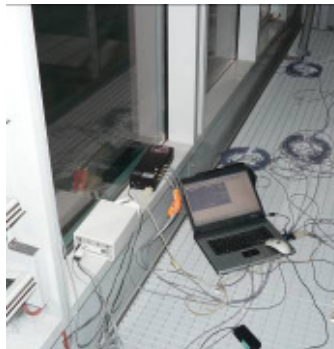
Injektion von Tracergas im Zuluftkanal (2)
